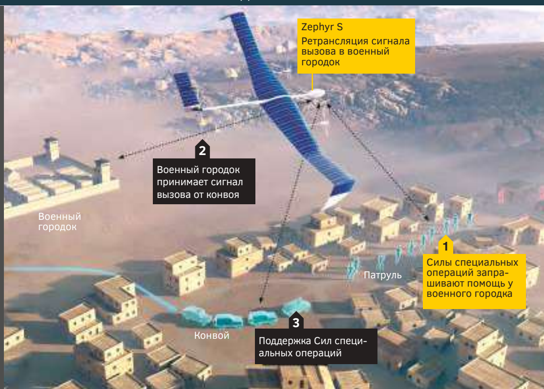
РИС. 9. ПРИМЕНЕНИЕ ПКА ZEPHYR S ДЛЯ ОБЕСПЕЧЕНИЯ СВЯЗИ
