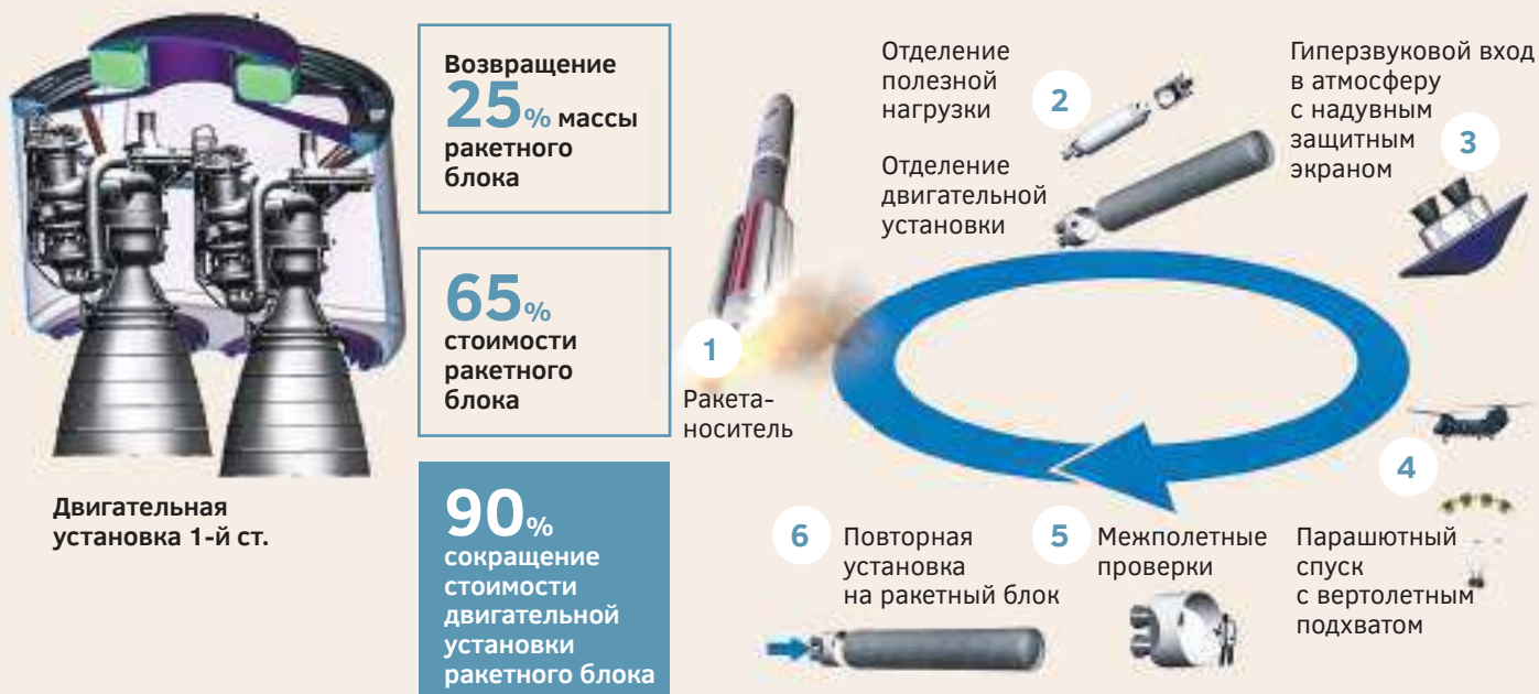
РИС. 4. SMART-ТЕХНОЛОГИЯ [17] ПОВТОРНОГО ИСПОЛЬЗОВАНИЯ МОДУЛЯ ДВИГАТЕЛЬНОЙ УСТАНОВКИ РАКЕТЫ-НОСИТЕЛЯ
