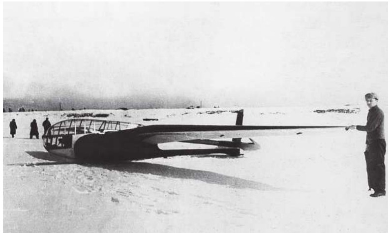
Рис. 5. Планер «Краних», модифицированный для пилотирования в лежачем положении
