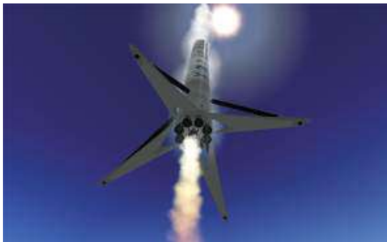
Рис. 10. Изображение конструкции посадочного устройства первой ступени ракеты-носителя Falcon 9 в процессе посадки
